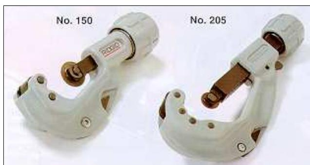
Le mod. 150 dispose d'une vis d'avance protégée, éliminant ainsi l'introduction de limaille ; de rouleaux rainurés permettant les coupes aux ras des collets, et d'un alésoir escamotable. Réalisé en résistante fonte d'aluminium, il est pourvu d'une molette de rechange dans le pommeau, et coupe cuivre dur et recuit, aluminium et acier mince. Le modèle 205 présente les caractéristiques du mod.150 plus une avance rapide sur crémaillère.
