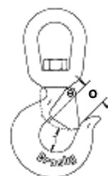
Dimensions d'un crochet à émerillon avec linguet renforcé
